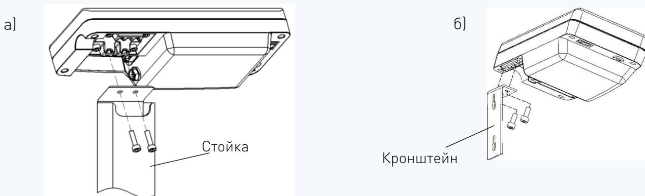
*Рис. 5.2. - Варианты крепления устройства управления*
